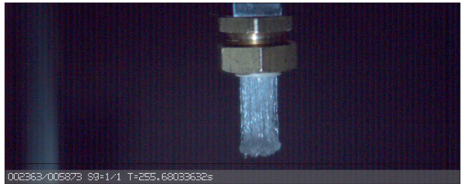
Abb 3: Schnelldosierung aufgenommen mit High-Speed-Kamera – Anfang
